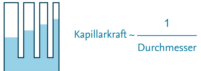
Abb. 3.3 Abhängigkeit der Kapillarkraft vom Durchmesser der Kapillare, erkennbar an der Steighöhe des Wassers
