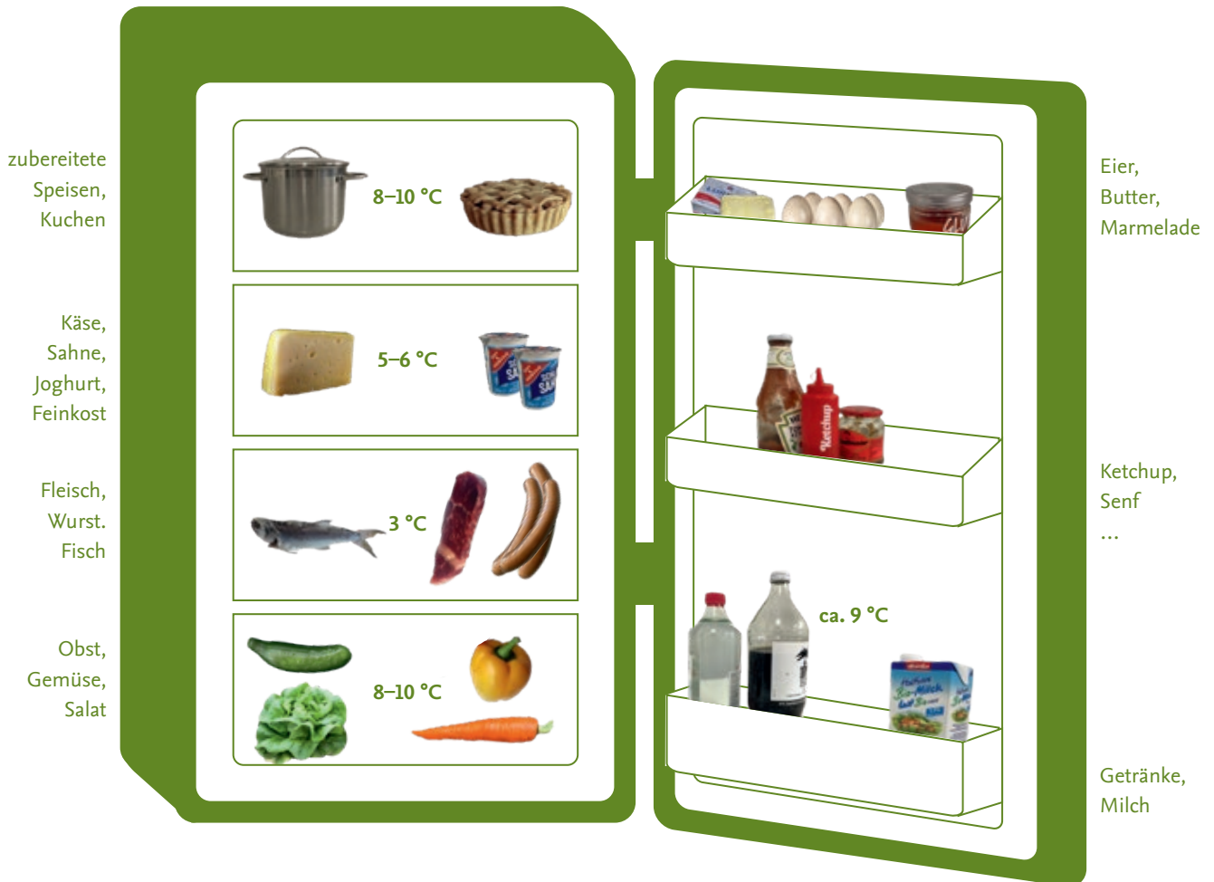
Abb. 7.1 Temperaturzonen im Kühlschrank
