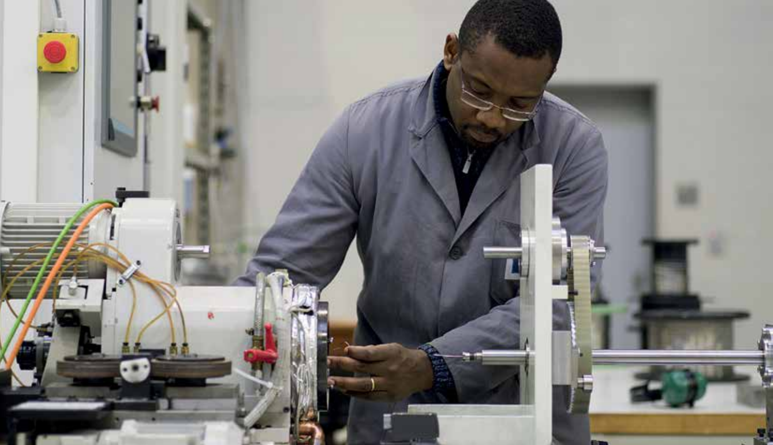
Ingenieur Eric Moumi bearbeitet Draht an der Rundknetmaschine. In dieser Maschine kann Draht dünner gemacht werden. Ebenso ist damit aber auch eine Verformung der Masseverteilung möglich (siehe Foto auf Seite 20).
