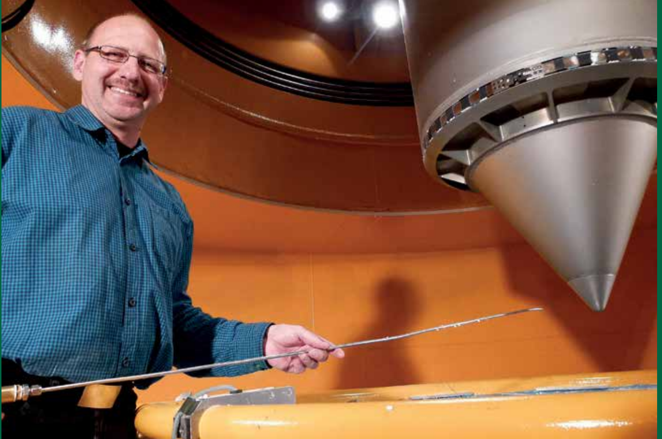
Torsten Lutz von der Fallturm-Betriebsgesellschaft mit der Kap- sel, in der die Experimente unter Schwerelosigkeit ablaufen.
