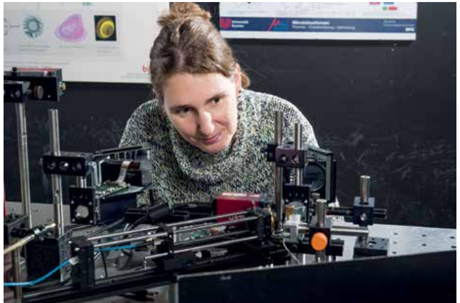
Die Physikerin Silke Huferath-von Lüpke prüft die Anordnung ihres Holografieaufbaus. Die Holografie wird im Sonderforschungsbereich als Messinstrument für die Werkzeuge und Werkstücke verwendet.
