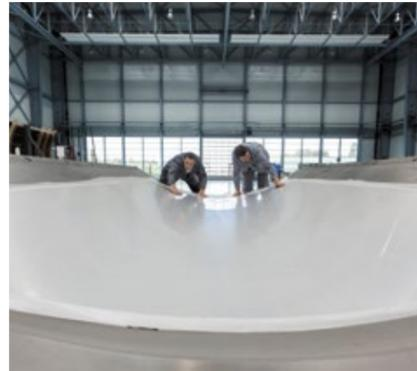
... ermöglichen die Fertigung trennmittelfreier XXL-Flugzeugrumpfschalen aus leichtem CFK.
