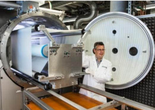
Im Niederdruck-Plasmareaktor beschichtete und funktionalisierte Flex<sup>PLAS</sup>-Trennfolien ...
