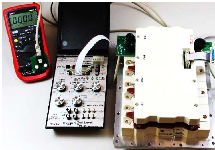
Abbildung 17: Niederspannungsscharakterisierung eines SKiiP3-Moduls
