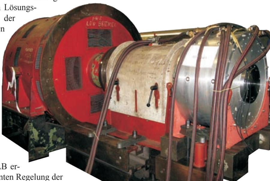
**Die Abbildung zeigt den Prüfstand des 50 kW-TFM-Generators. Im Hintergrund befindet sich die große Antriebsmaschine, die an den kleinen silberfarbigen TFM-Generator gekuppelt ist. Die Größenverhältnisse vermitteln einen Eindruck der extrem hohen Drehmomentdichte des Generators. Die auf engem Raum gebündelte Leistung erfordert ein effektives Kühlkonzept, man sieht die an den Generator angeschlossenen Wasserschläuche.**
