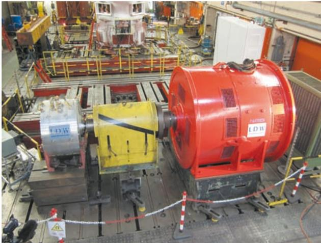
**Abb. 1: Messaufbau im Prüffeld (Links: 8.7 kNm TFG, Rechts: Gleichstromantrieb)**
